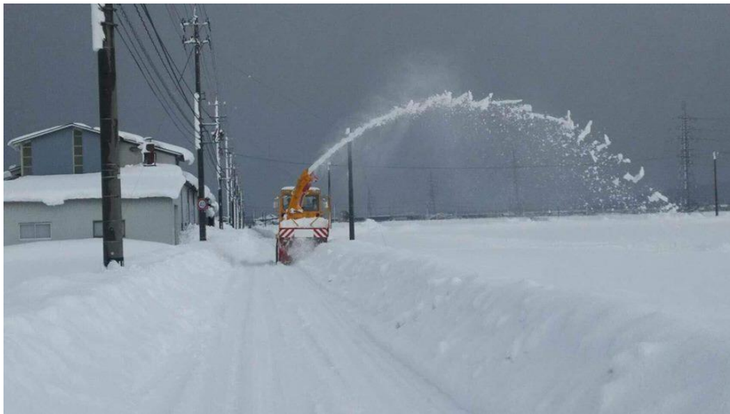
国道河川事務所による大型ローリーによる除雪作業の様子
